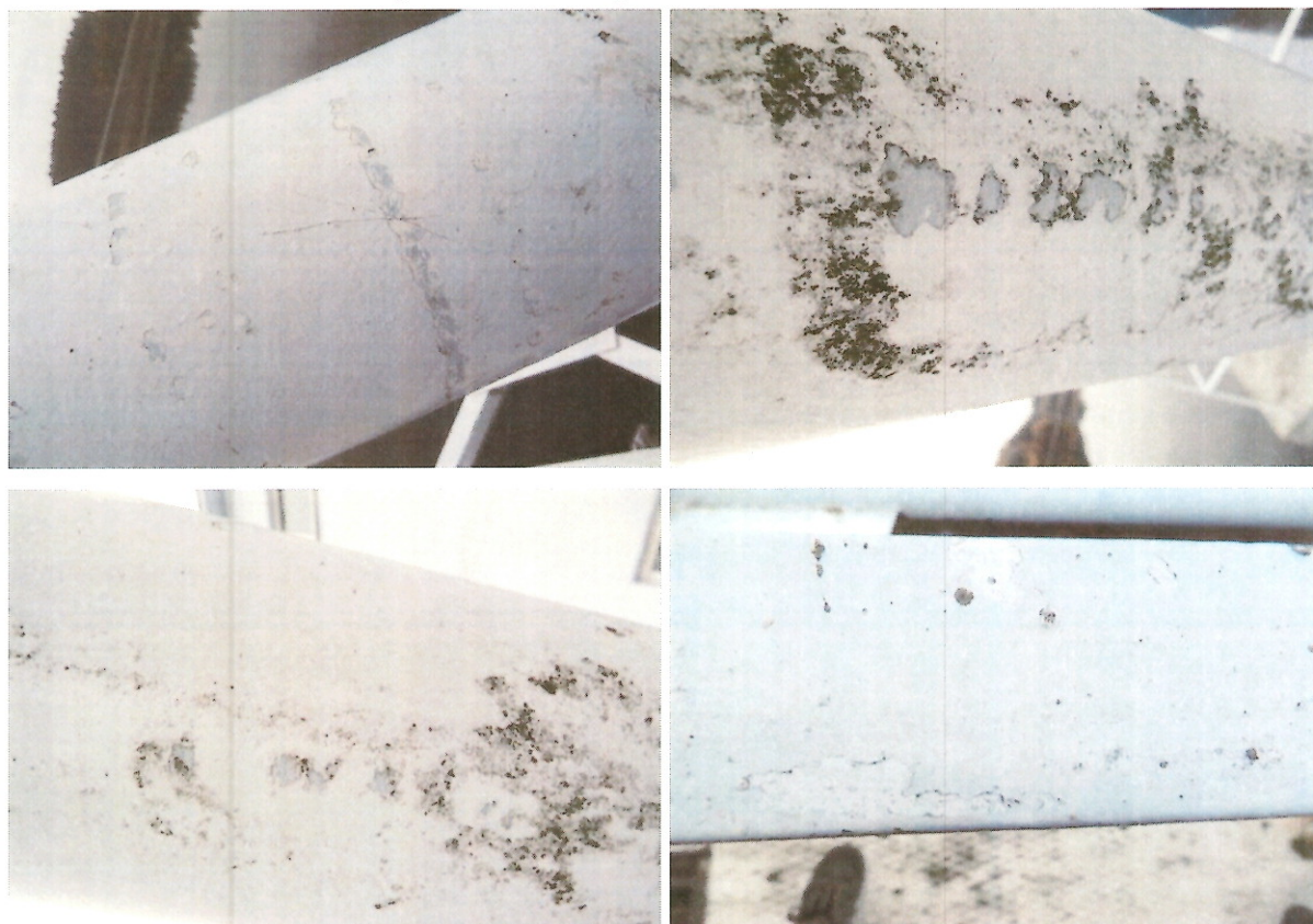
Obrázek 3 Mechanické poškození, odlup vrchního nátěru
